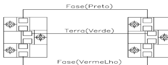
Circuito Elétrico 220V
