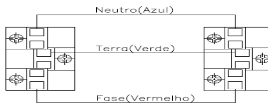
Circuito Elétrico 127V
